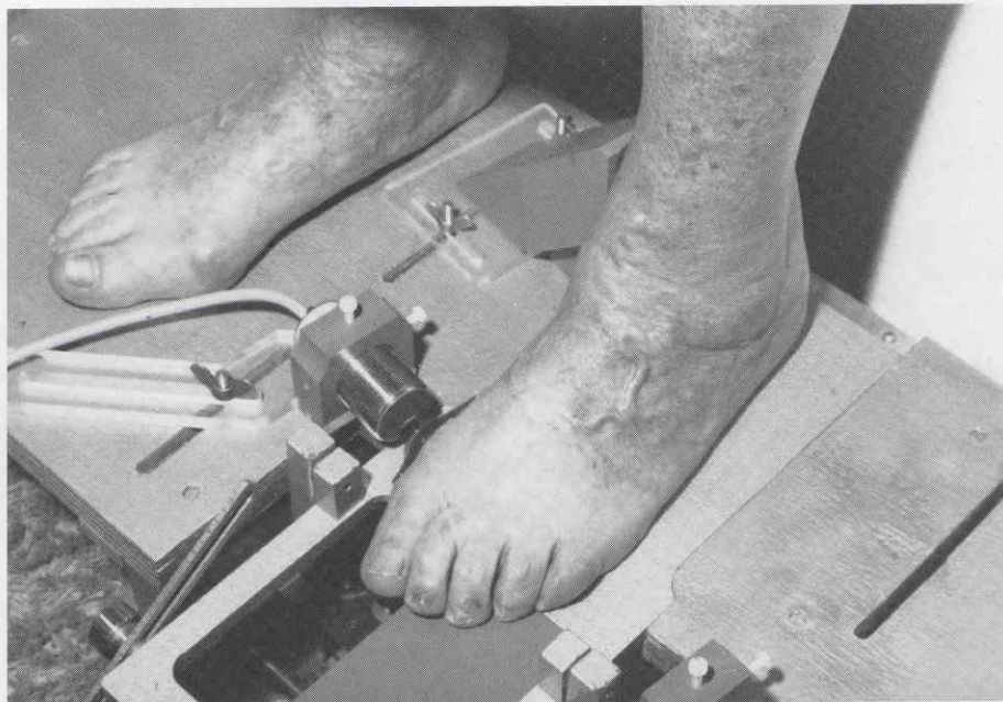
De foto toont de proefopstelling met een teenkrachtmeter onder de grote teen en een contactloze afstandsmeter bij de knok.
